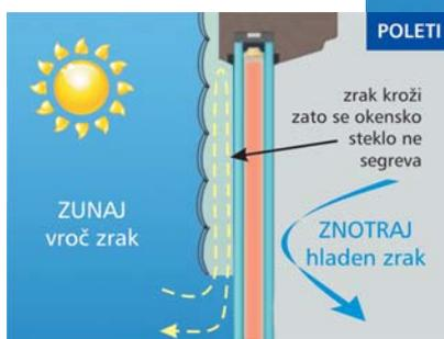
Toplotna izolacija; pozimi zmanjšate stroške ogrevanja do 30%, poleti lahko ustavite do 80% vročine. Rolete so varčna in zdrava »hladilna naprava«.
