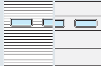
Izvedba s sendvič okni tipa A Višine vratnih elementov: 500, 625, 750 mm
