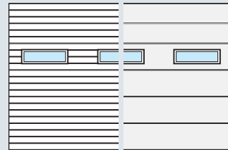
Izvedba s sendvič okni tipa D Višine vratnih elementov: 500, 625, 750 mm
